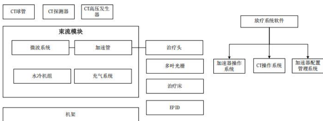
图 2-4 直线加速器主要系统组成
